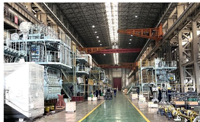
中国ライセンシー GDF社工場(内観) (UEエンジンを連続生産中)
