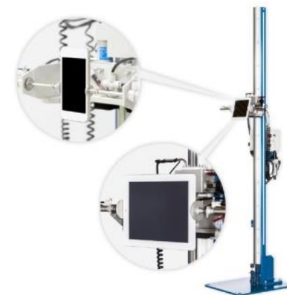
携帯端末用落下試験機 (神栄テクノロジー株式会社製)
