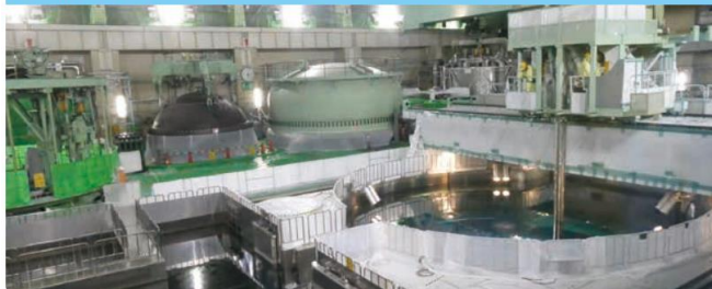
②燃料装荷(写真は原子炉に燃料集合体を挿入する作業の様子)
