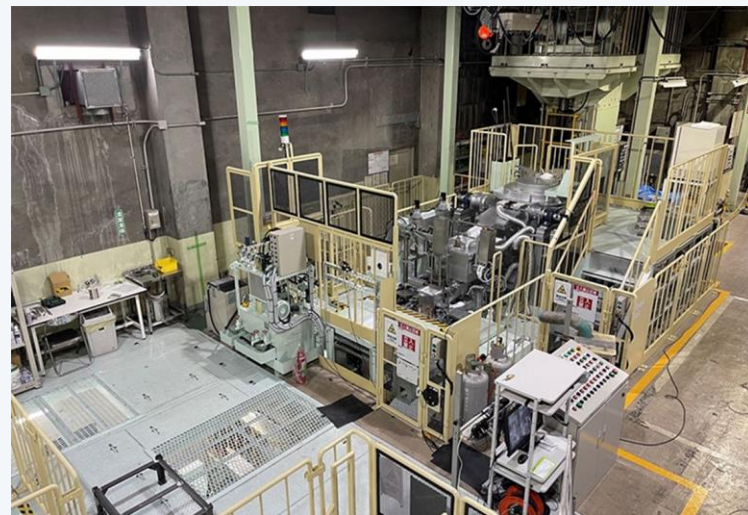
縦型高速双ロール鋳造実験機 (R&Dセンター：名古屋)
