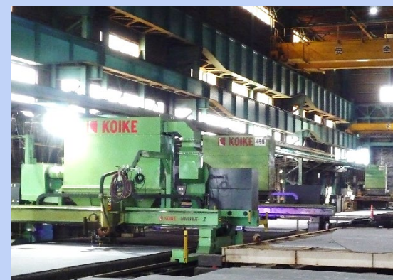
(NCプラズマ切断機)
