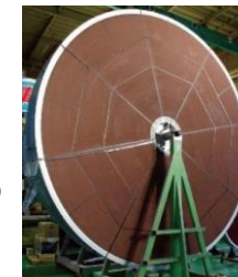
VOC濃縮ローター
