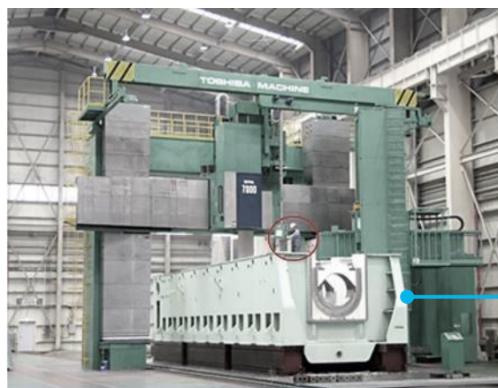
石油・ガス運搬用タンカーエンジン加工 超大型工作機械
