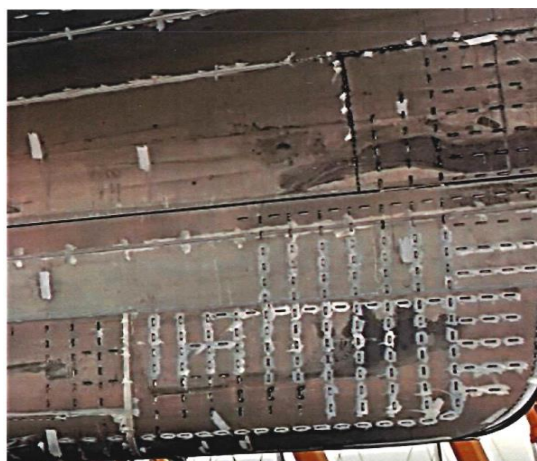
【図5：船首部分の右舷側の外板にあるスロット溶接のためのスロット部分】
