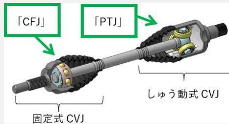
EV向け高効率・低振動ドライブシャフト
