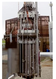
液体水素ポンプ
