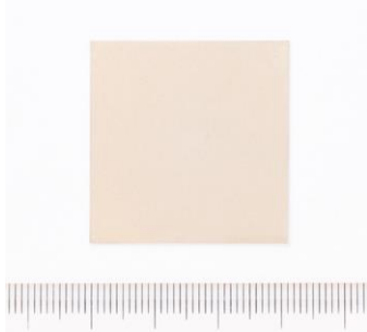
EDPの30x30mm大型ダイヤモンド単結晶
