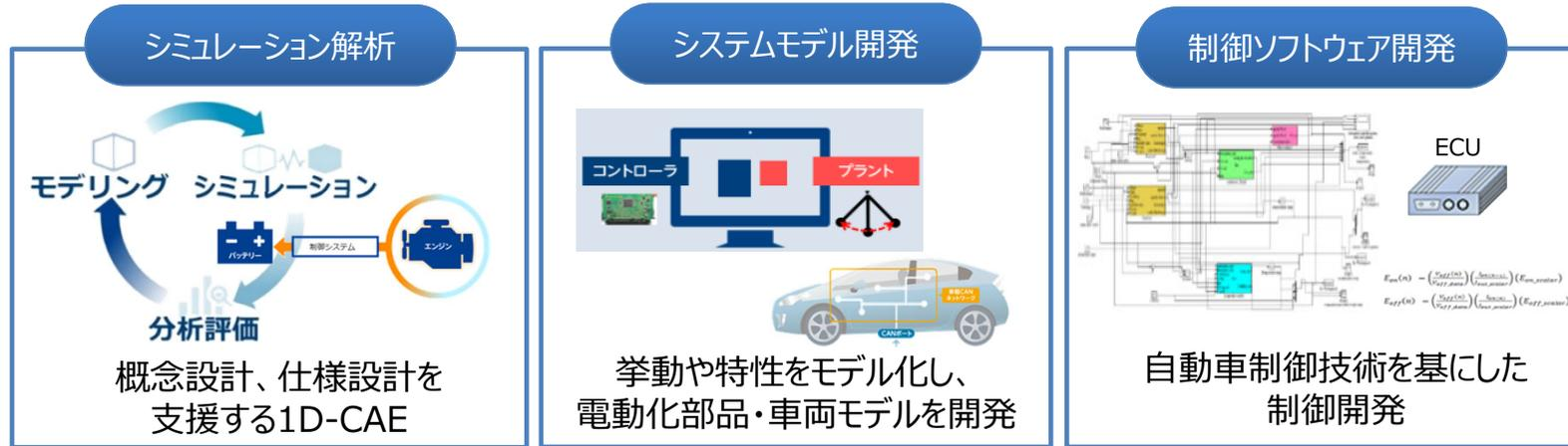
1D-CAE：製品設計前に、機能ベースで製品全体を表現し、評価解析することで、製品開発上流段階での全体適正設計を可能とする手法
